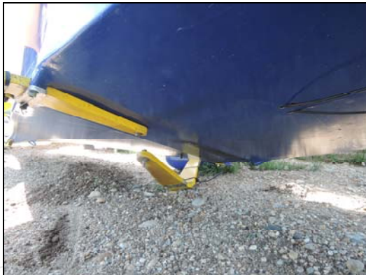
Fig. 2 – Trenul de aterizare stâng desprins
